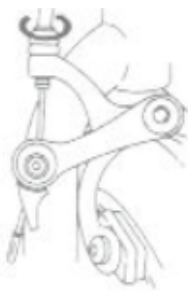
rys. 12b regulacja napięcia linki hamulca
